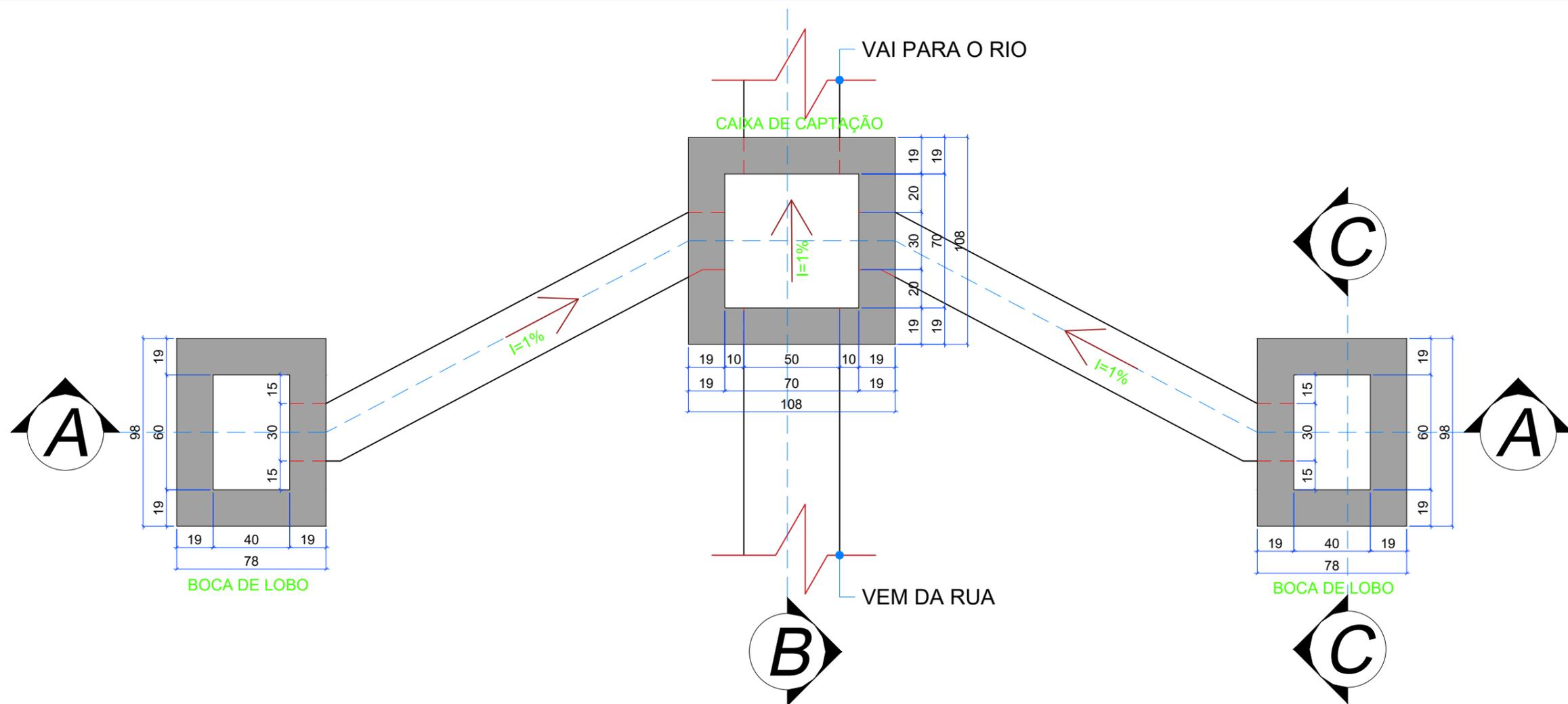
**PLANTA BAIXA BOCAS DE LOBO E CAIXA DE CAPTAÇÃO**
