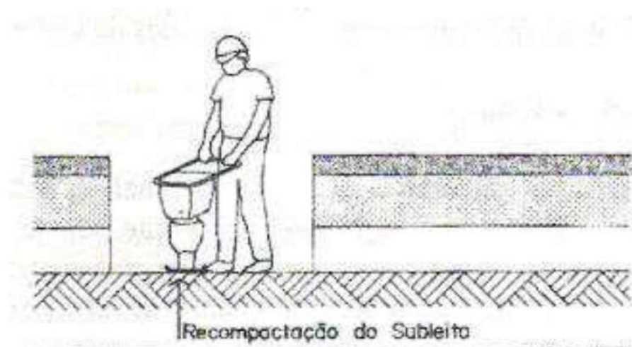
Figura 6: Readequação do subleito.
