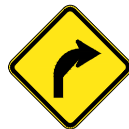
PLACA ADVERTÊNCIA A-2b L= 0,50m
