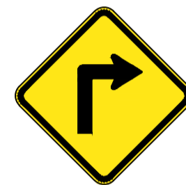
PLACA ADVERTÊNCIA A-1b L= 0,50m
