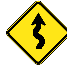
PLACA ADVERTÊNCIA A-3b L= 0,50m
