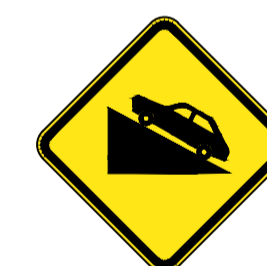
PLACA ADVERTÊNCIA A-20b L= 0,50m
