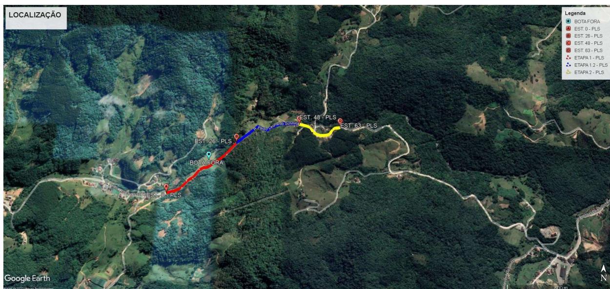
Em vermelho é demonstrada a pavimentação da Etapa 1 do projeto, sendo a Etapa 1 iniciando na estaca 0 a 26 e a Etapa1.2 iniciando na estaca 26 e finalizando na estaca 48 e a Etapa 2 iniciando na estaca 48 e finalizando na estaca 63.
