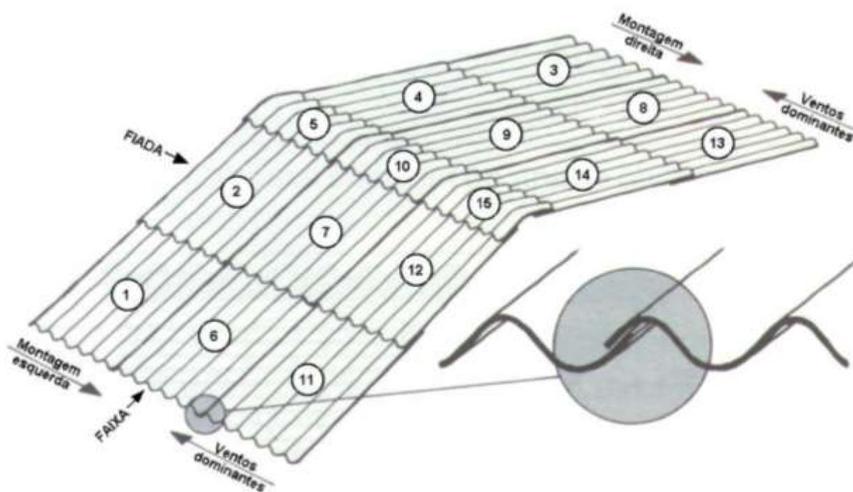
Figura Montagem de um telhado, com telhas de fibrocimento modelo "ondulada". Fonte: ETERNIT (2002)
