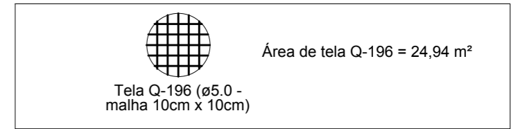
DETALHE DA TELA PARA CAPEAMENTO DA LAJE PREMOLDADA
